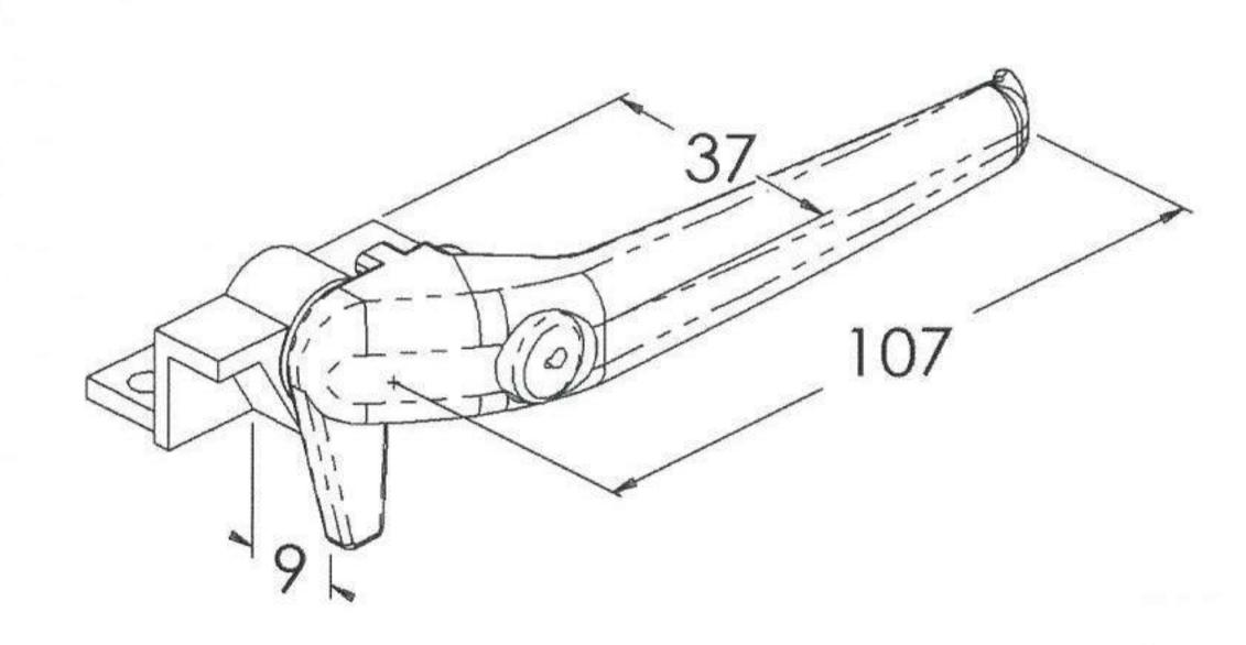
RECOMMENDED FIXING 2 x 8g x 5/16" PAN POSI SCREWS TYPE B PART No 8014 2 Holes Ø 3.3mm 25.5
